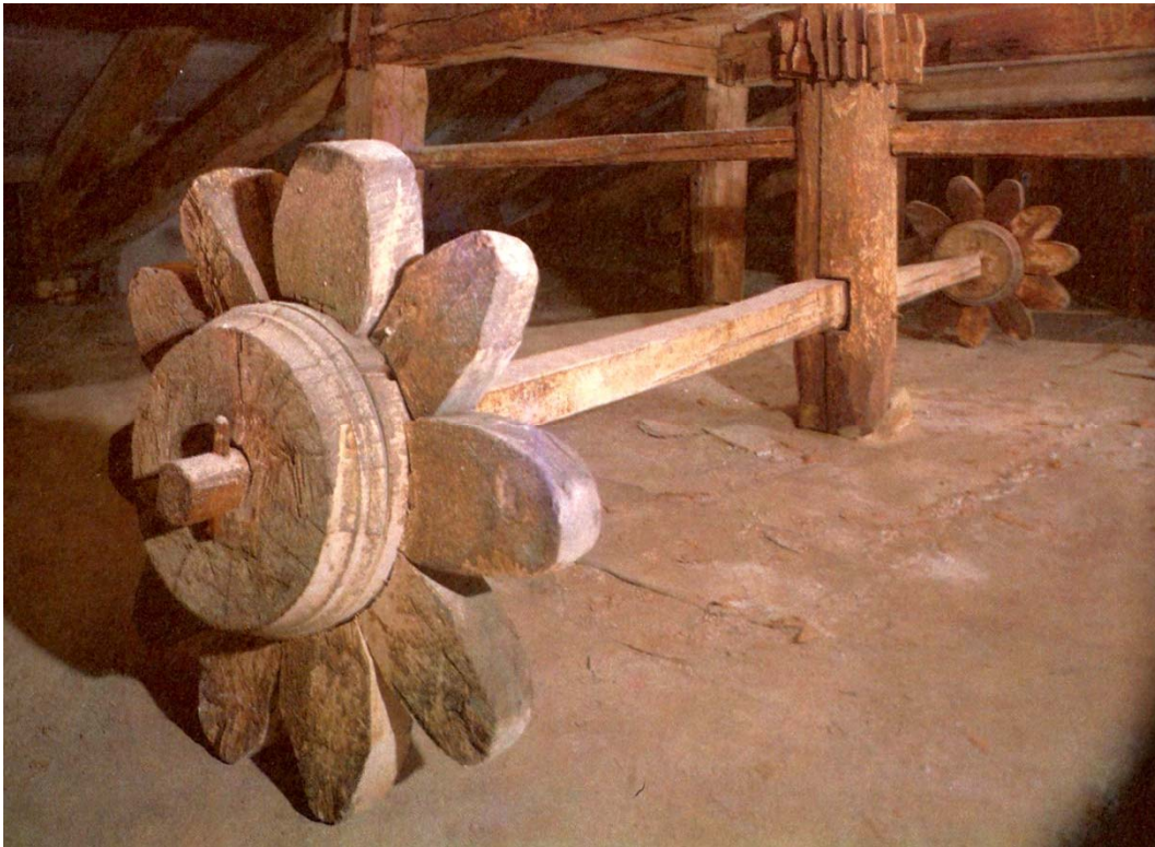
Fig. 13, dispositivo per il tuono, Ostankino, XVII sec.
