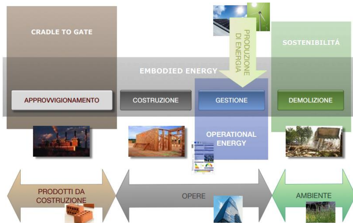
Figura 7. Analisi delle fasi di calcolo delle differenti tipologie di energia incorporata in un prodotto edilizio
