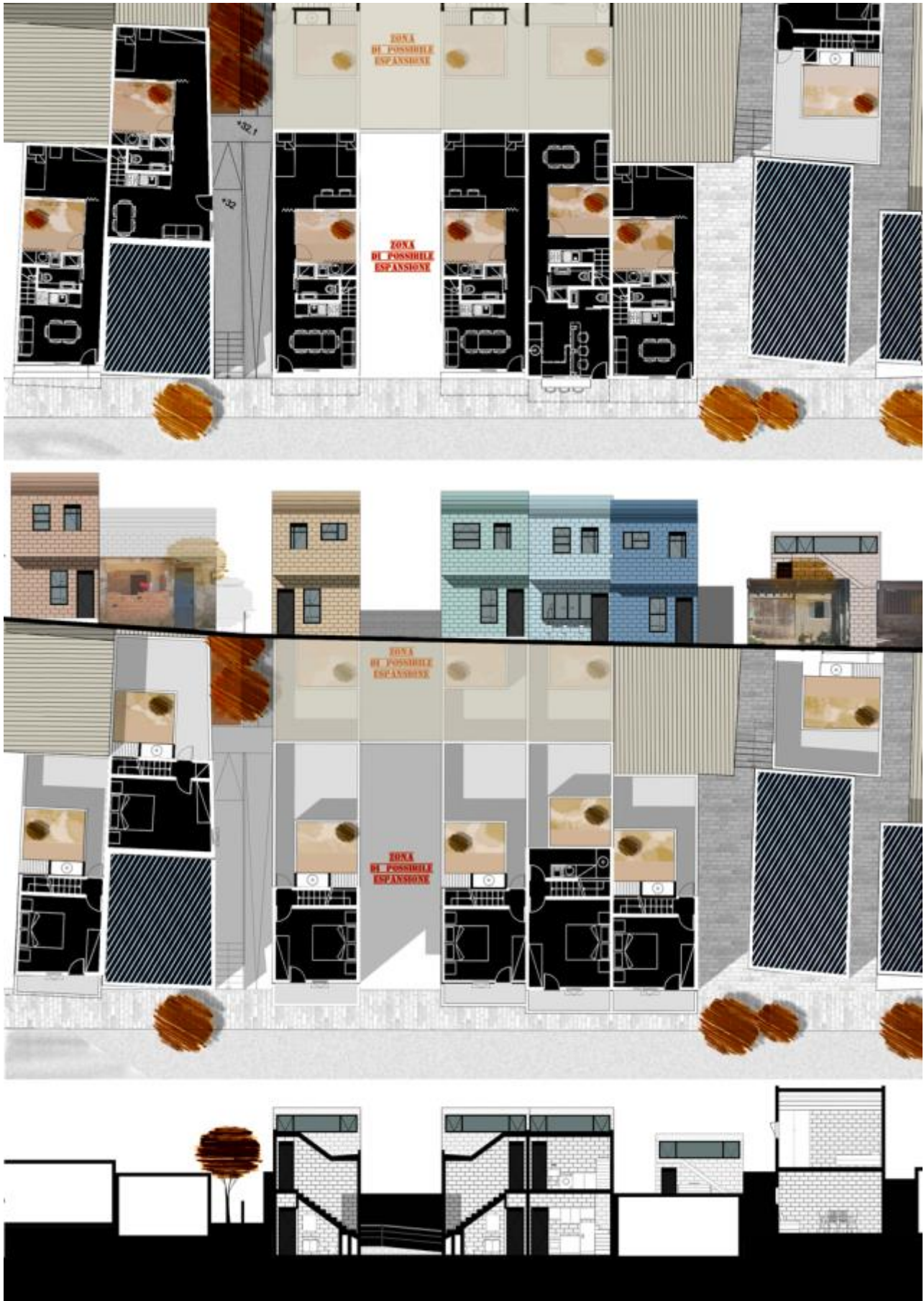
Fig. 7 Sistema insediativo. Piante dell'abitazione e della variante commerciale (primo e secondo livello), sezione e prospetto (C. Bonomo).
