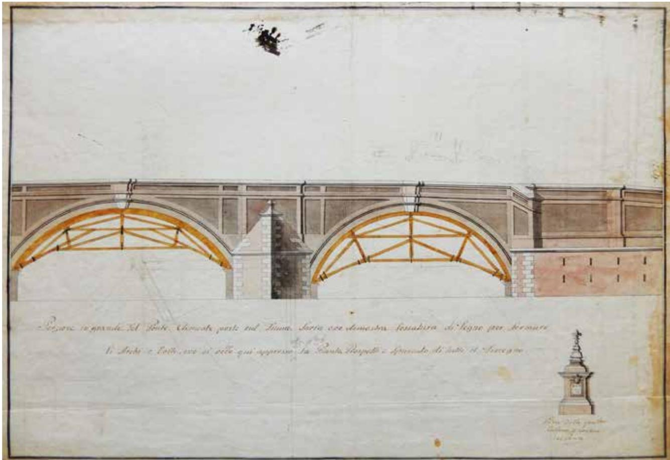
**Fig. 3.C.22** - BM, Raccolta Comandini, Armadio XLIII, coll. 74g3 – Cesena, P. C. Borboni (attr.), *Porzione in grande del Ponte Clemente posto sul Fiume Savio ove dimostra l'ossatura di legno per formare li archi e volti ove si vede qui appresso la Pianta Prospetti e Spaccato di tutti il Dissegno, prospetto* (1768ca.), copia di M. Guidi (fine XVIII secolo).
