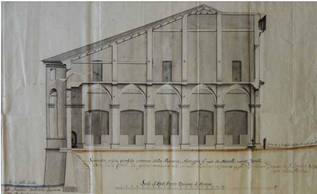
Fig. 3.A.13 - ASCe, Archivio Storico Comunale, vol. 740 – Cesena, P. C. Borboni, *Spaccato, o sia profilo interno della Pescaria, Boteghe per uso de Macelli, e suoi fenili*, sezione (1767).
