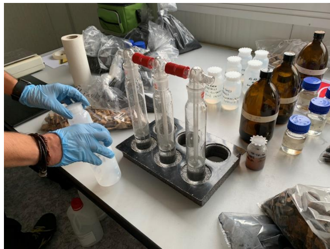
Figura 20: Una fase della preparazione dei gorgogliatori per il campionamento del tar
