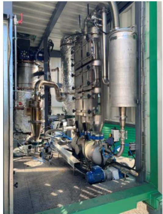
Figura 19: A sinistra la rappresentazione grafica di reattore (1), sistema di raccolta delle ceneri (2), ciclone (3) e scambiatore di calore (4). A destra un'immagine con i filtri per la pulizia del syngas.
