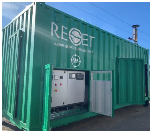
Figura 18: Impianto di gassificazione a letto fisso downdraft CHP20
