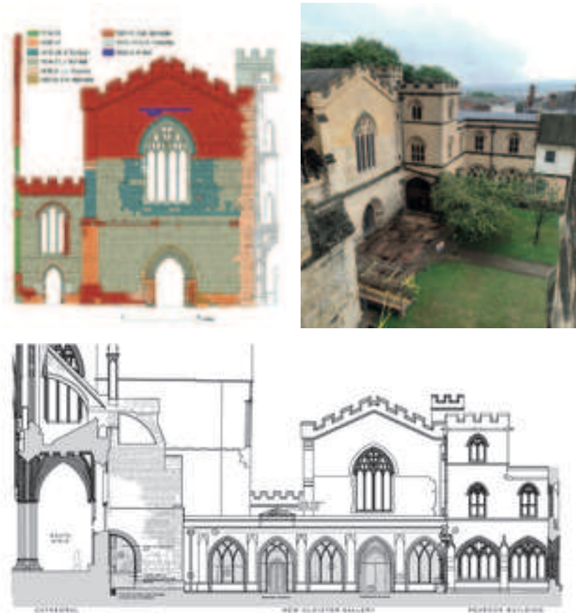
Fig. 6. Proposal for a new cloister gallery for the Exeter Cathedral: drawings presented in January 2022 to the casework committee for comments. Initial architectural thoughts for a new portico were discussed together with materials used, reversibility of connection, modern and traditional approach, reversibility of new elements within the historic structure. Comments were made by expert members of the committee, which will respond with a letter to the project architect or the council conservation officer responsible for the project planning and listed building approval / Proposta progettuale per la realizzazione di un nuovo portico nel chiostro della Cattedrale di Exeter presentata alla commissione per il restauro nel gennaio del 2022. Le prime idee progettuali sono state elaborate considerando la scelta dei materiali, la reversibilità dell'intervento, il linguaggio moderno e tradizionale impiegato, la reversibilità dei nuovi elementi nel contesto della struttura storica. I membri del comitato hanno espresso alcune opinioni e risponderanno con una lettera ufficiale all'architetto, autore del progetto, o al responsabile della conservazione all'interno della Commissione responsabile per la pianificazione e approvazione dei progetti su edifici storici. (© Acanthus Clews Architects) [ https://www.spab.org.uk/news/casework-exeter-cathedral ]
