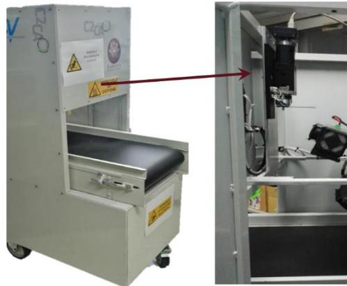
Figura 4.2. Sistema iperspettrale VIS-NIR: dispositivo ImSpector V10E.
