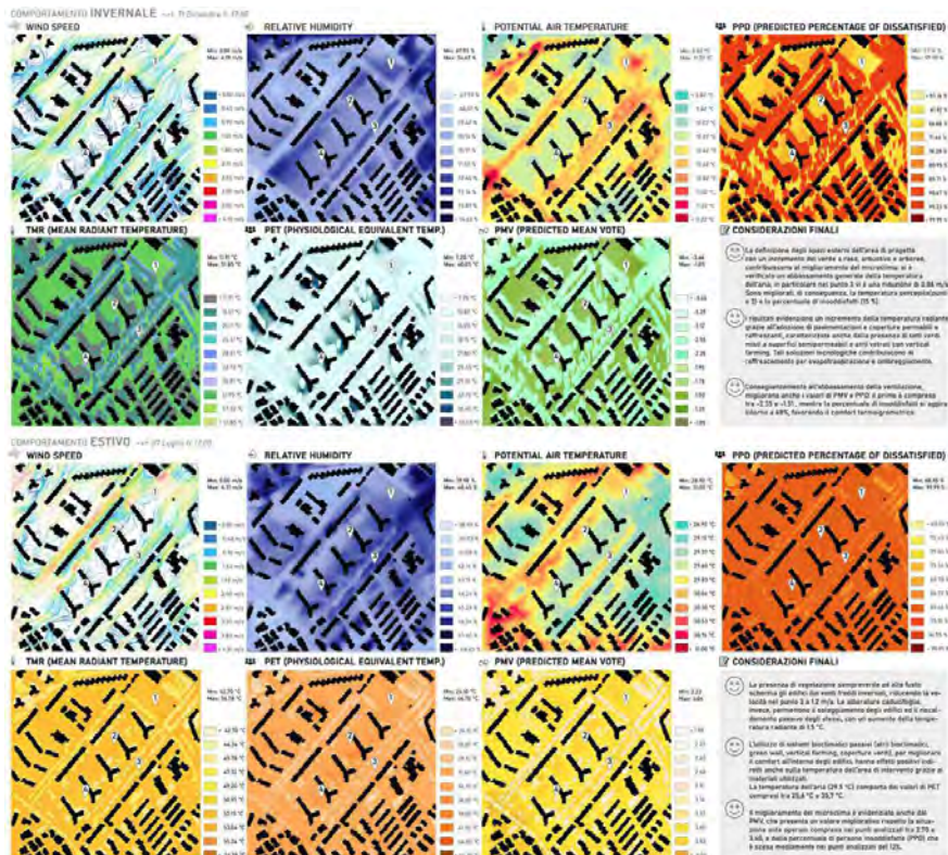
Fig. 33: Simulazioni dei principali comportamenti bioclimatici invernali ed estivi nello stato post operam della Zona Urbanistica 5e - San Basilio
