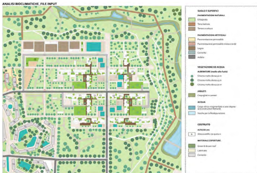
Fig. 41: Planimetria dell'area di intervento con indicazione delle trasformazioni di trattamento materico del PdZ 02-V San Basilio.
