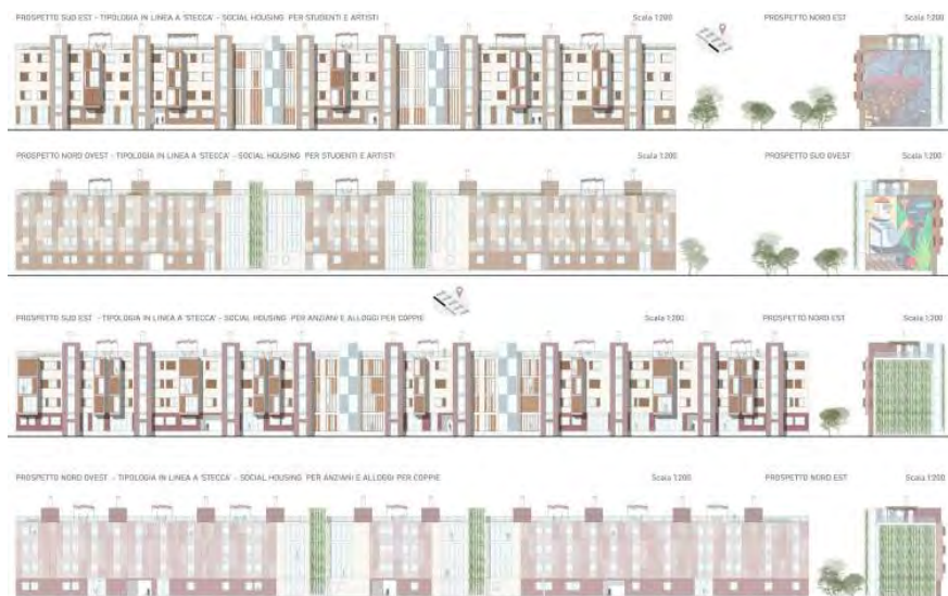
Fig. 31: Prospetti di un edificio residenziale tipo oggetto di rigenerazione urbana nella Zona Urbanistica 5e - San Basilio.
