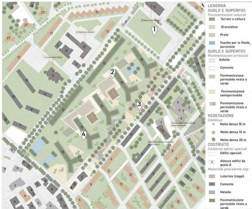
Fig. 34: Planimetria dell'area di intervento con indicazione delle trasformazioni di trattamento materico della Zona Urbanistica 5e - San Basilio
