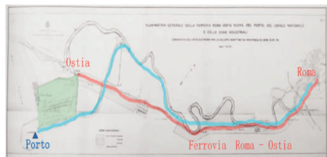
2.15/ Planimetria generale della ferrovia Roma-Ostia Nuova, del porto, del canale navigabile (la parte in azzuro) e delle zone industriali (la parte in verde) eseguita dall'Ente autonomo per lo Sviluppo Marittimo ed Industriale di Roma (SMIR).
