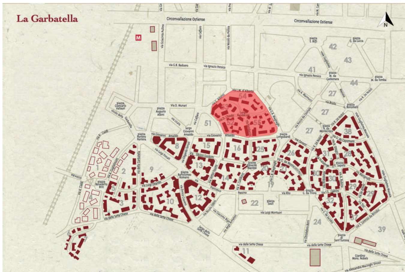
2.45/ Planimetria generale della Garbatella, scala originaria 1:5000. In rosso sono evidenziati i lotti 52-53-54 e 55 costruiti nel periodo 1926-1927.
