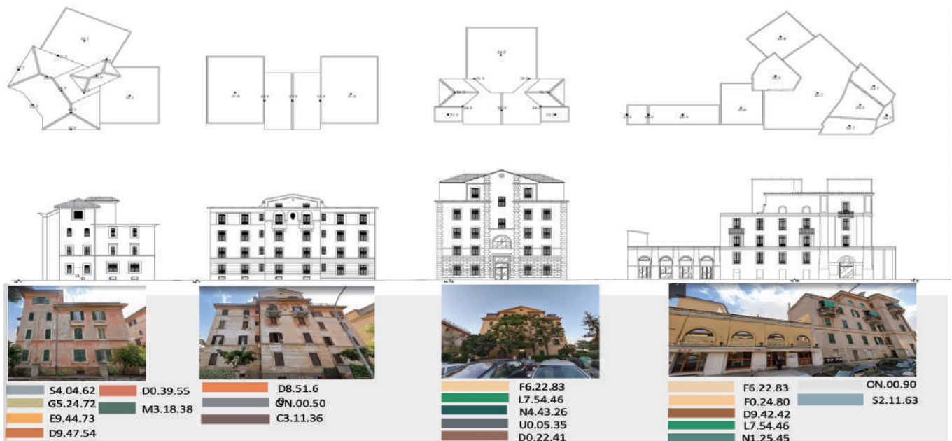
3.33/ Restituzione complessiva del dato: geometrico, percettivo e cromatico dei fronti rilevati lungo altro lato di Via Giustino de Jacobis (scala 1:250), realizzato dall'autrice.
