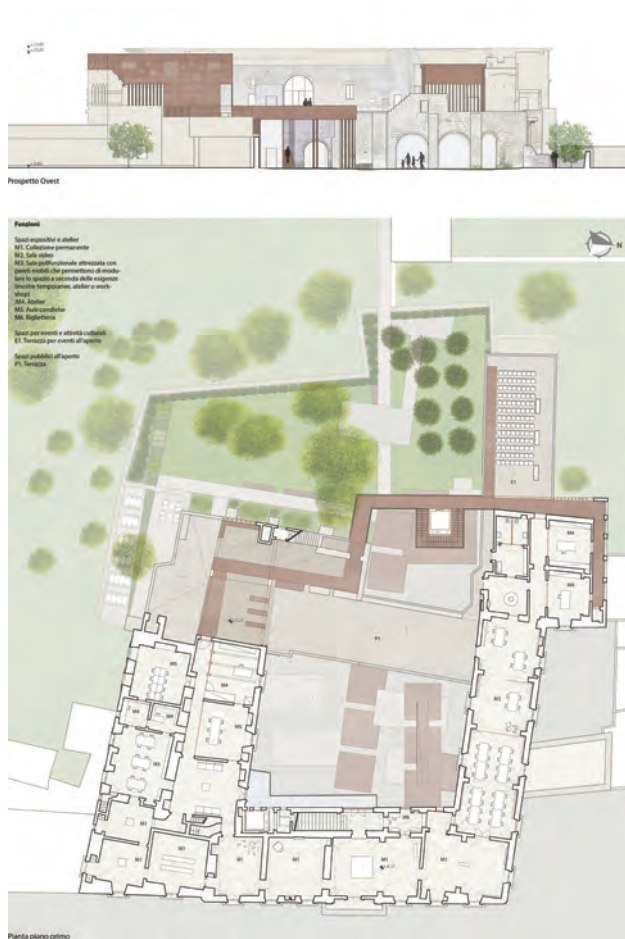
Fig. 29. Elisa Beccarini (2016). Progetto di restauro di Palazzo Vernazza. Il progetto prevede di destinare il palazzo a polo culturale intervenendo nel ridisegno dello spazio aperto con un sistema di pavimentazioni in pietra leccese, corten e pietra viva. All'interno del palazzo sono previste attività espositive, una biblioteca, spazi per bambini, sale per eventi culturali e residenze per artisti.
