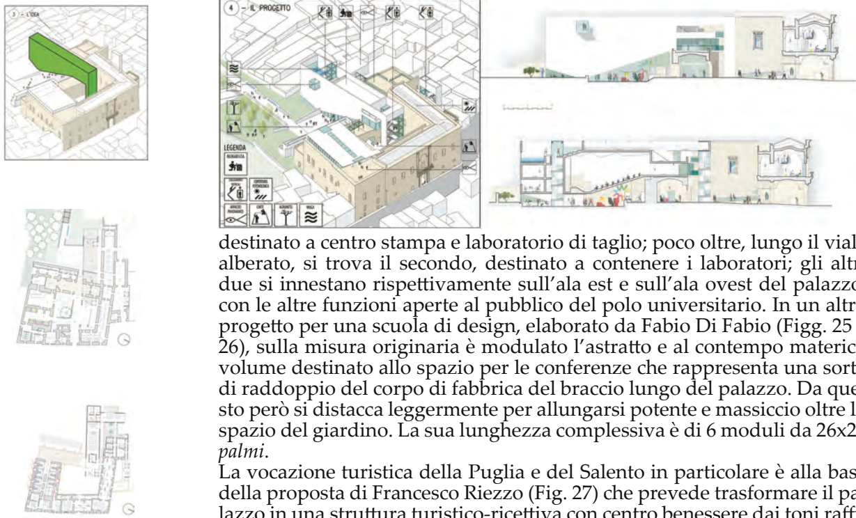
Fig. 26. Fabio Di Fabio (2016) Assonometria del palazzo: in verde il nuovo volume della sala conferenze. Pianta del piano terra e pianta del piano superiore.
