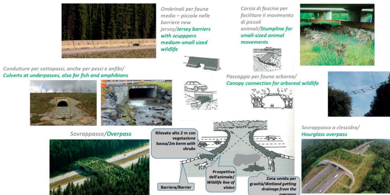
Figura 5 – Dispositivi di mitigazione che favoriscono la permeabilità della via (rielaborazione da fonti varie).
