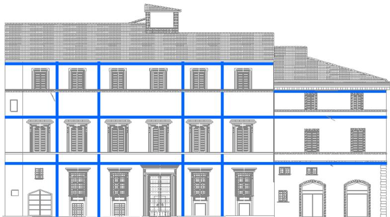
Fig. 251 – Schema possibile di applicazione di una catena verticale in acciaio
