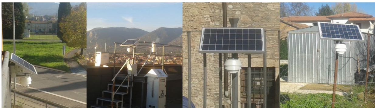
Fig. 18: Smart Sampler installati nella città di Terni in 4 diversi siti.
