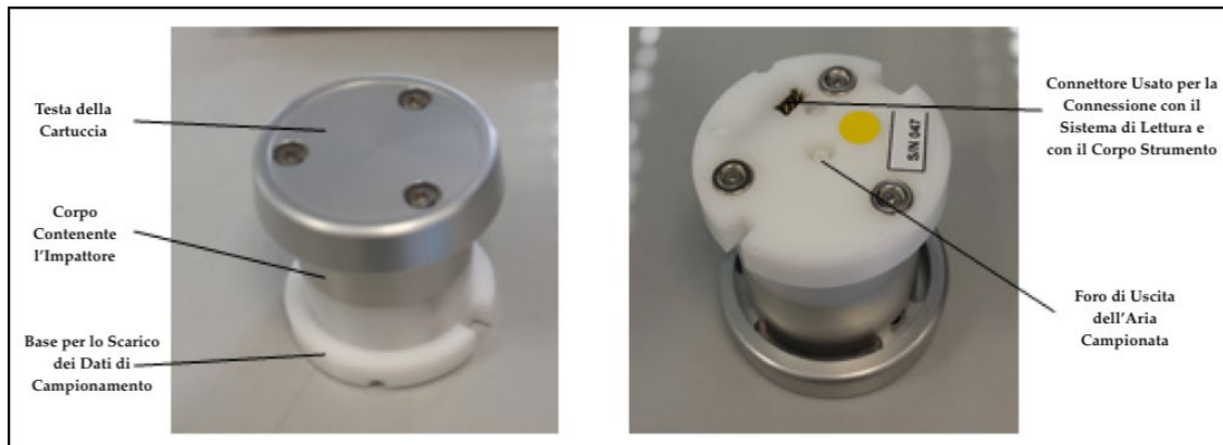
Fig. 23: Visione superiore (sinistra) e inferiore (destra) della cartuccia di campionamento.
