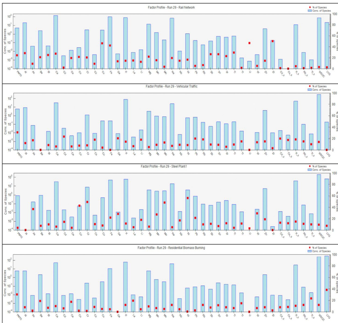
Fig.40: Profili di sorgente ottenuti per la ferrovia, il traffico veicolare, l'acciaieria e la combustione delle biomasse. Gli istogrammi rappresentano il rapporto tra gli elementi caratteristici della sorgente; i punti rossi rappresentano invece la percentuale di ogni elemento associata a ciascuna sorgente.
