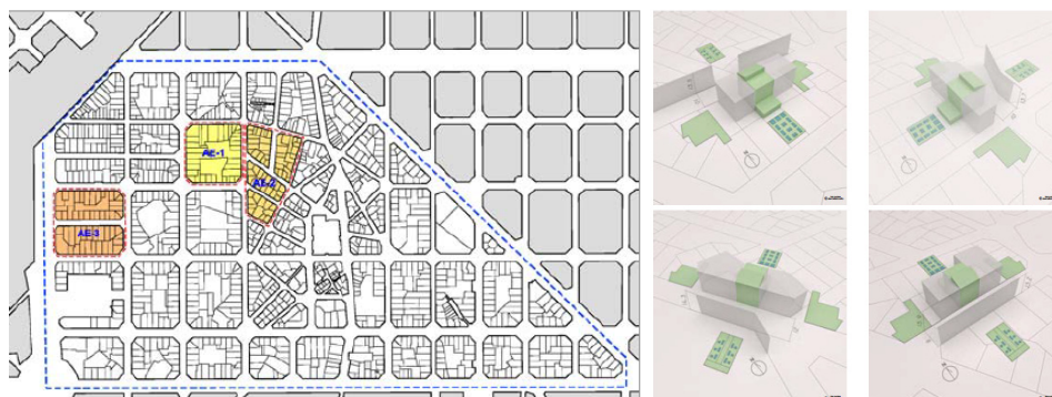
Tratto da Jiménez Alcañiz, C. (2014). Nel tessuto edilizio del barrio sono stati individuati 3 ambiti di studio, caratterizzati da conformazione spaziale differente, e per ognuno di questi è stata analizzata una unità tipo, analizzandola a seconda dei differenti orientamenti.
