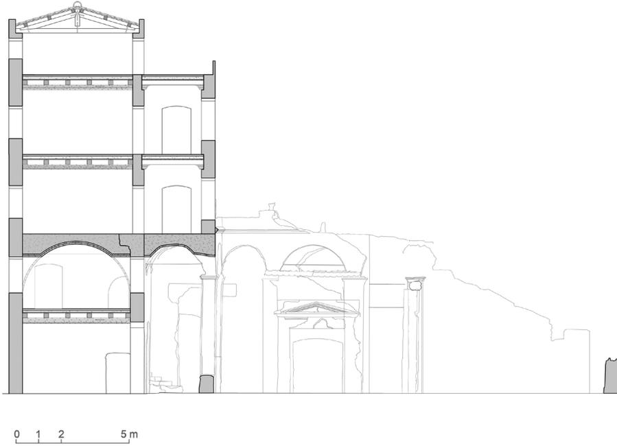
Fig. 3. Sezione – stralcio della porzione orientale del Casggiato. Ipotesi ricostruttiva dell'autore.
