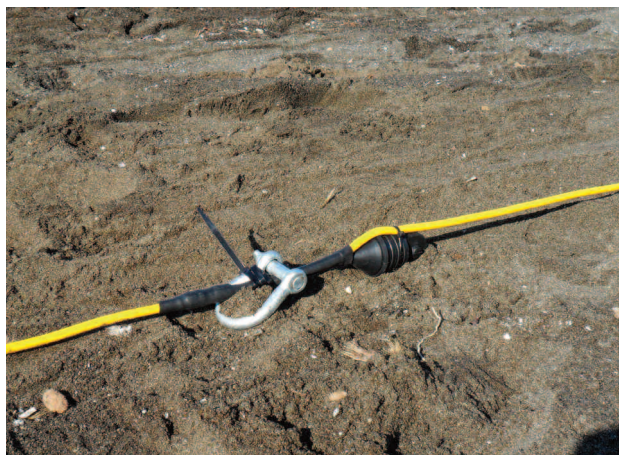
Figura 44 Idrofono. In corrispondenza di ogni idrofono, sono stati legati dei maniglioni (300 g.) per meglio favorire la discesa in profondità. Figure 44 Hydrophone. In correspondence of each hydrophone was tied a shackle (300 g) for facilitating the cable descent in depth.
