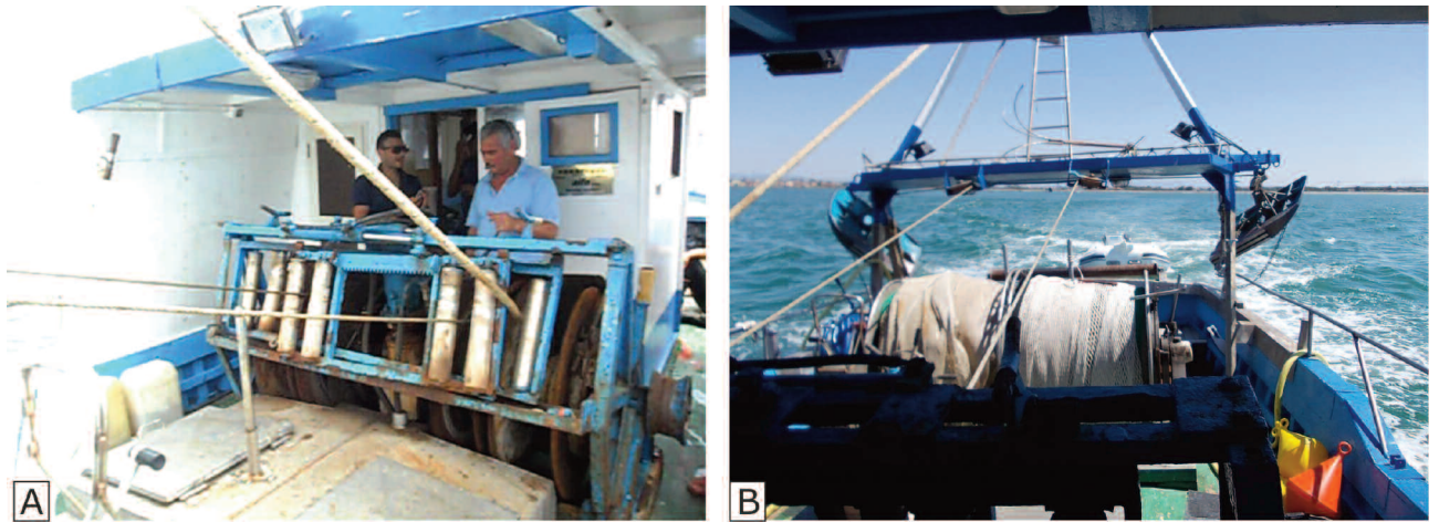
Figura 46 A) Particolare del verricello a due tamburi che comanda i due cavi d'acciaio. B) Veduta dell'arcone di poppa. Figure 46 A) Detail of the double-drum winch which controls the two steel cables. B) View of the boat arch stern.
