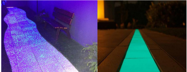
Figura 8 - Applicazione del cemento fotoluminescente su percorso pedonale e come segnaletica stradale. Fonte: Italcementi
