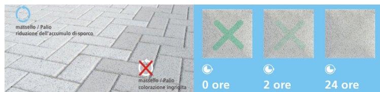
Figura 18 - Confronto tra pavimentazione in biossido di titanio e tradizionale, capacità di degradazione di un tratto di pennarello su una superficie con biossido di titanio. Fonte: https://www.paver.it/sostenibilita/serie-fotocatalitica
