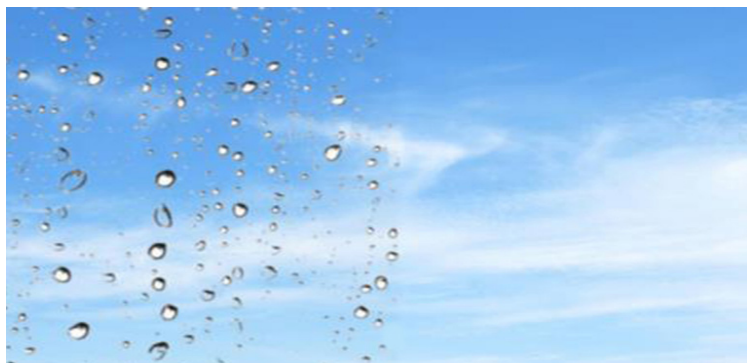
Figura 19 - Esempio di un vetro senza (a sinistra) e con applicazione di pellicola fotocatalitica (a destra). Fonte: https://www.airlite.com/2021/02/25/airlite-tecnologia-unica-nel-mondo/
