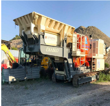
Figura 29 - Impianto mobile per il trattamento dei rifiuti inerti.
