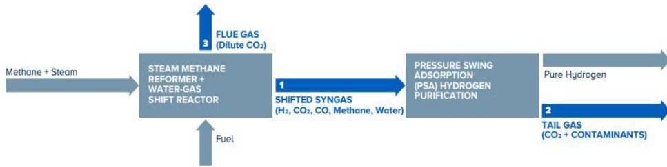
Figura 64 - Diagramma di flusso del processo per un SMR idrogeno SMR. Fonte: (IEA, 2019)
