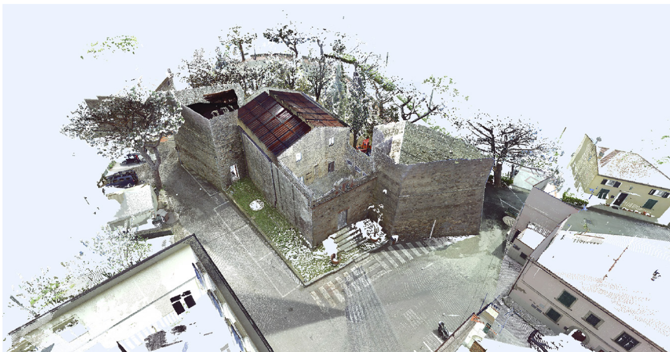
Fig. 5.4 Screenshot della nuvola di punti della Chiesa di San Niccolò: Acquisizione mediate TLS dell'isolato in cui è inserita la chiesa.
