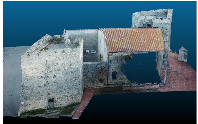
Fig. 5.8 Chiesa di San Niccolò: risultato dell'acquisizione fotogrammetrica da drone.
