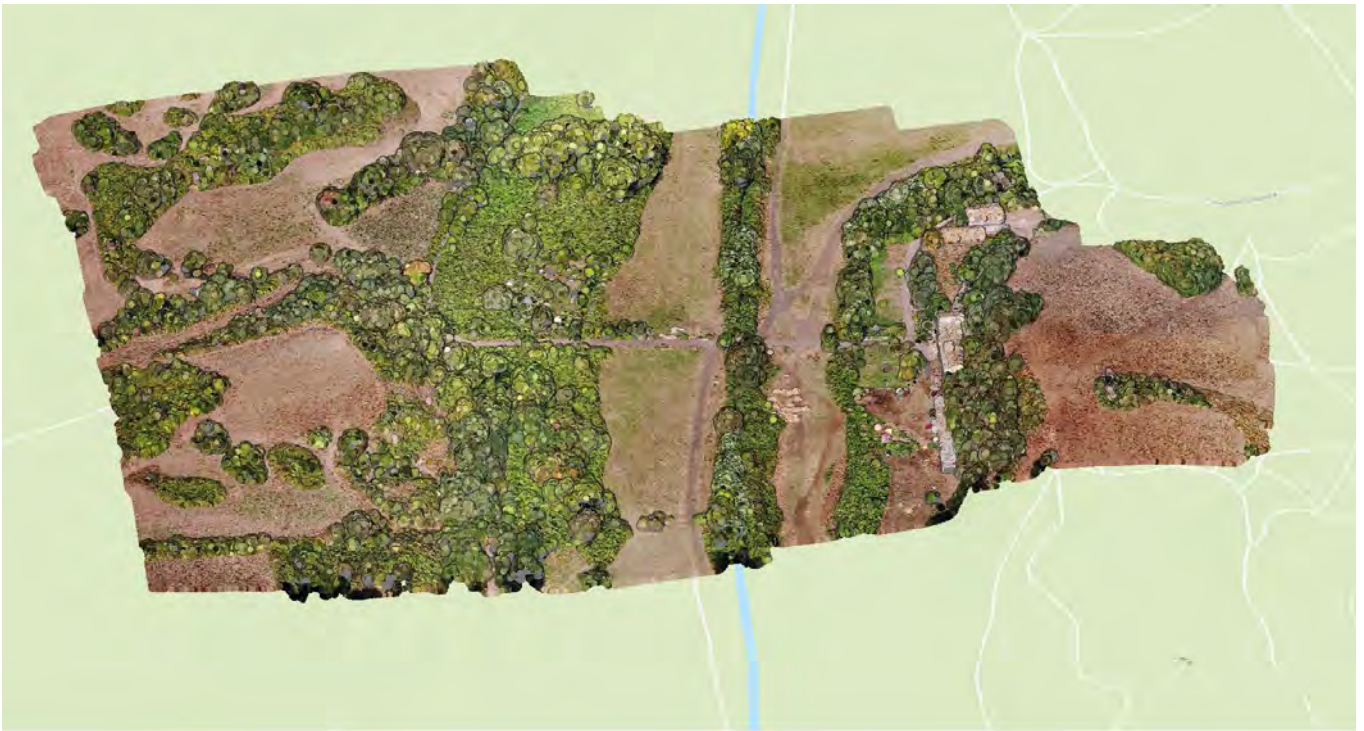
9/ Nuvola di punti importata in GIS, georeferenziata e visualizzata con il dato RGB. Sullo sfondo, come basemap, è stata inserita la mappa topografica. Il confronto con la figura precedente consente una comprensione maggiore dell'andamento orografico dell'area (elaborazione in ESRI - ArcGIS Pro 2.7).
