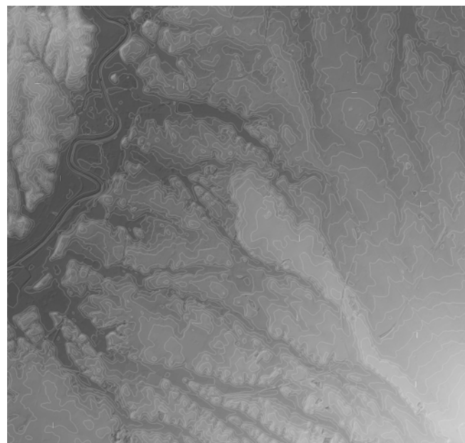
35/ Rappresentazione del terreno sviluppata attraverso una integrazione tra DEM e curve di livello. Queste sono state estratte e ricavate direttamente dal DEM (elaborazioni in ESRI - ArcGIS Pro 2.7).
