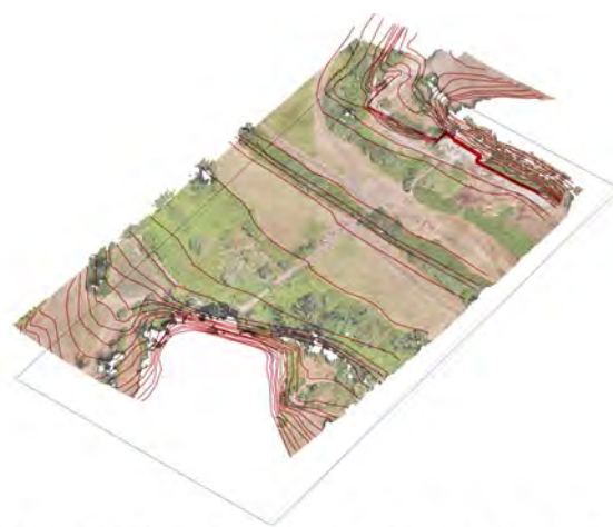
2) Nuvola di punti e isoipse fino alla quota +36 s.l.m.
