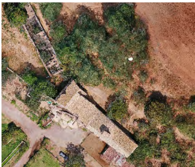
10/ Nuvola di punti importata in GIS, georeferenziata e visualizzata con il dato RGB (elaborazione in ESRI - ArcGIS Pro 2.7).
