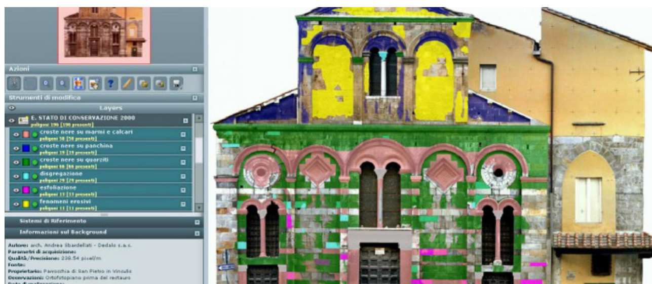
Fig. 3. Esempio di schermata del sistema informatico SICaRweb impiegato per il restauro della chiesa di S. Pierino in Vinculis a Pisa (< http://sicar.beniculturali.it:8080/website/ > [25/1/2019]).
