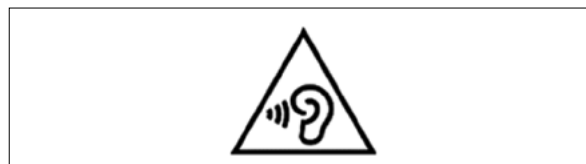
Figura 1. Avvertenza per rischio danno uditivo: comprende un simbolo con un'altezza minima di 5 mm e la seguente dicitura o simile: To prevent possible hearing damage, do not listen at high volume levels for long periods.
