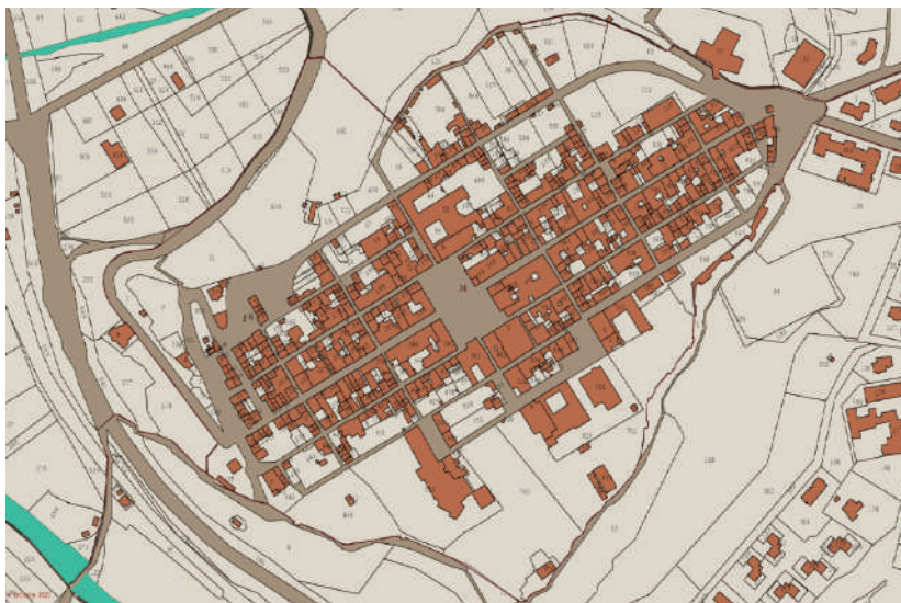
Fig. 1. Planimetria catastale acquisita mediante il servizio di consultazione Web Map Service (WMS) dell’Agenzia delle Entrate e rielaborata attraverso il software open source QGIS. Si evidenzia la configurazione regolare dell’impianto caratterizzato dalla presenza di una griglia ortogonale di strade che facilita le operazioni di perimetrazione delle Unità Urbane.
