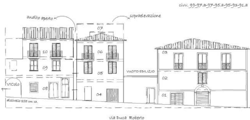
Fig. 3. Rappresentazione grafica del fronte, che prospetta su via Duca Roberto, di una delle UU-A analizzate. Sono riportate alcune delle informazioni riscontrate in fase di campagna e necessarie alla compilazione della scheda.
