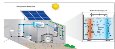
Figura 167: Servizio igienico autopulente ad energia solare
