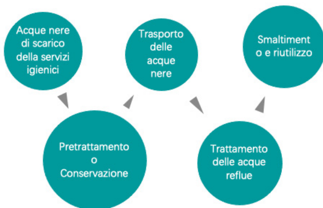
Figura 159: Modello del ciclo di vita delle acque nere dal servizio igienico da trattare
