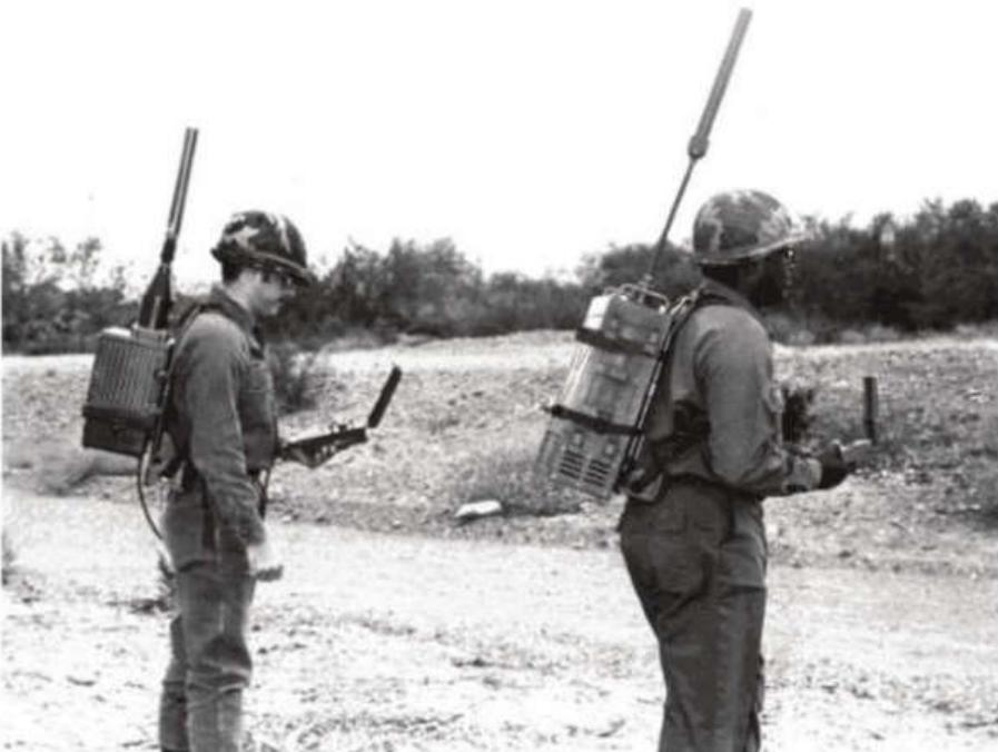
Due militari testano un primo modello di ricevitori GPS da spalla (1978).
