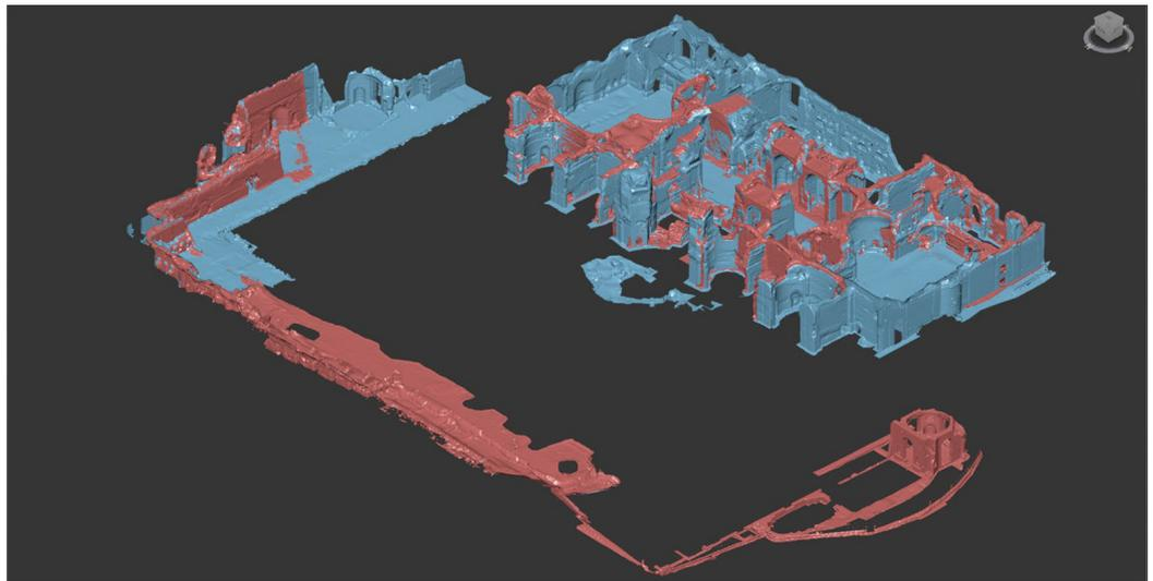
Fig. 5. Integrazione tra la 'mesh' proveniente dal TLS (in blu) e la 'mesh' acquisita con fotogrammetria (rosso).
