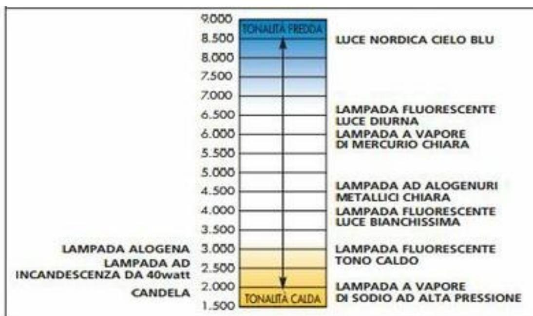
Figura 39. Scala delle temperature di colore (K) [Fonte – <http://www.energiaenergetica.enea.it>]
