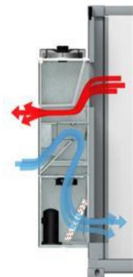
*Figura 33. Esempio di un sistema free-cooling diretto*
