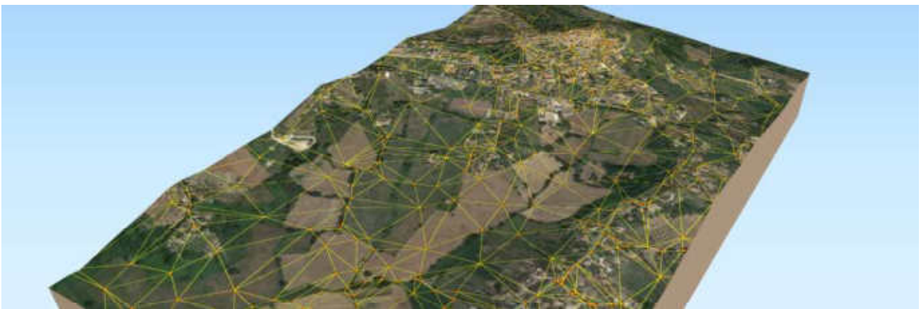
3.9 Triangolazione TIN effettuata sulla base di dati territoriali di un comune del Lazio. L'elaborazione è stata eseguita sfruttando le potenzialità dei sistemi GIS (QGIS)
