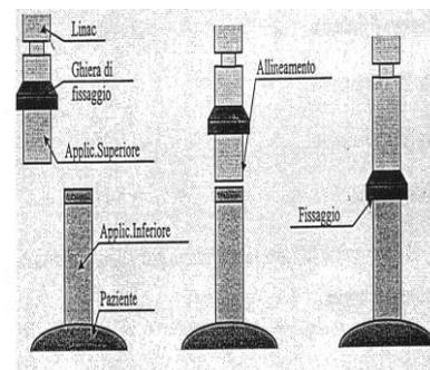
I collimatori in dotazione al NOVAC7 sono divisi in due parti: la parte superiore viene saldamente fissata all'acceleratore mentre quella inferiore viene in contatto con il paziente ed è tenuta fissa mediante dispositivi meccanici in genere facenti capo al letto operatorio.
