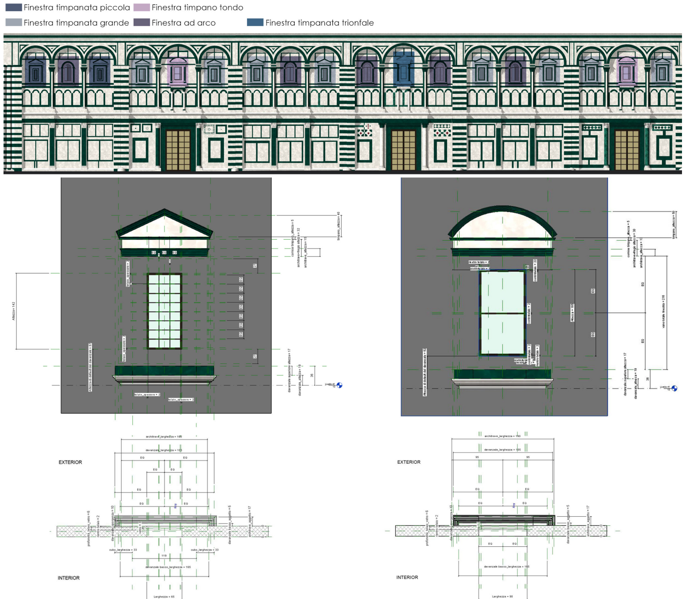
3.16/Modellazione delle finestre architravate con timpano tondo e triangolare. Impostazione dei parametri in pianta e alzato all'interno della famiglia caricabile; estrusione delle cornici in place ed inserimento nel browser di progetto delle semicolonne e paraste come famiglie caricabili nidificate. Nel centro: mappatura delle tipologie di finestra modellate realizzata sull'ortofoto del modello stesso.
