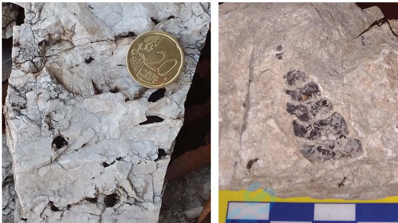
Fig. 5 - Bitume concentrato nella porosità primaria delle dolomie triassiche. Nella foto a sinistra il bitume occupa cavità dovute alla presenza di organismi indeterminabili, mentre a destra riempie un gasteropode.
