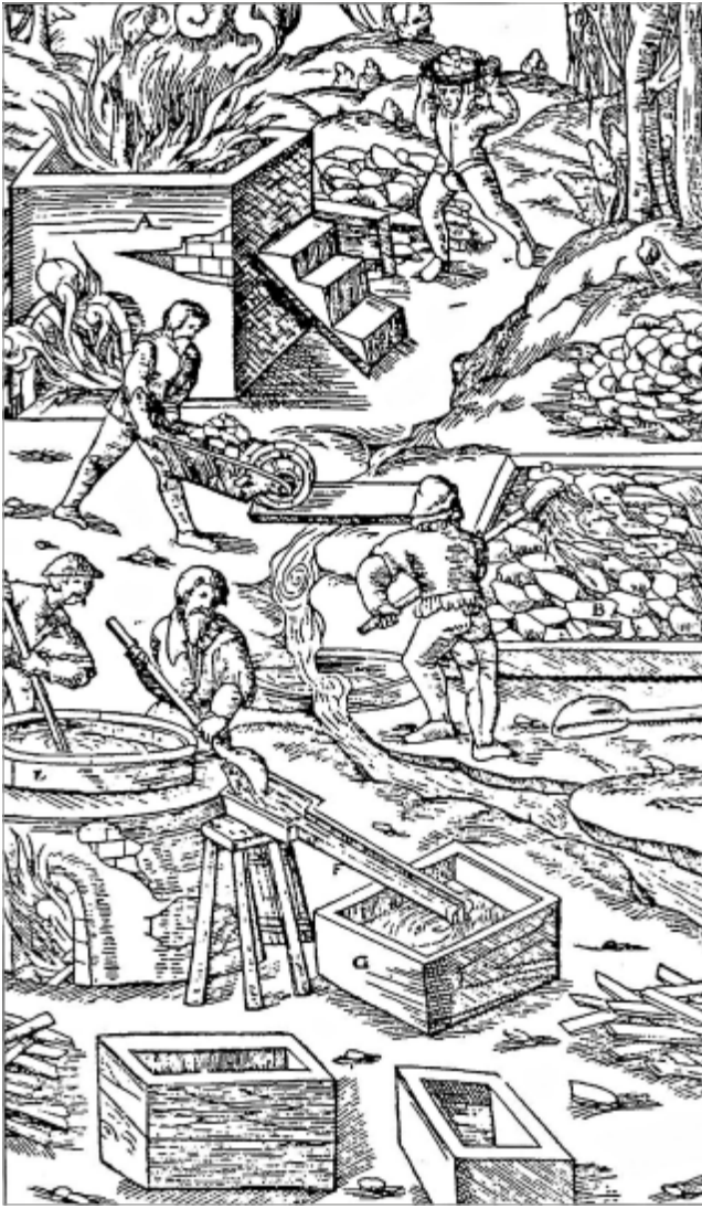
fig. 7 – Le fasi di lavorazione dell'alunite riportate nel "De Re Metallica" di Giorgio Agricola.
