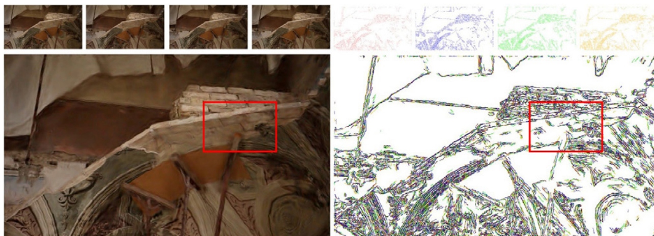
Fig. 4. Frame del video processato con algoritmo PBMM a 25 Hz (a sinistra); Sovrapposizione di frame del video processato con algoritmo PBMM a 25 Hz e Canny Edge Detection (a destra).
