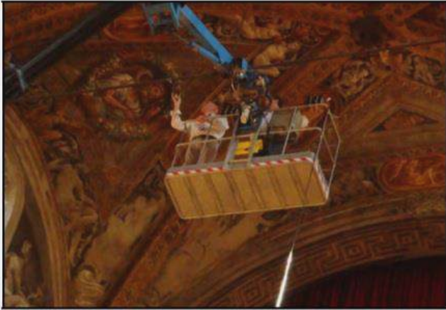
Figura 1.2.13 Attività sperimentale di determinazione dello stato tensionale delle catene presso il Duomo di Parma (GARZIERA, COLLINI 2009)
