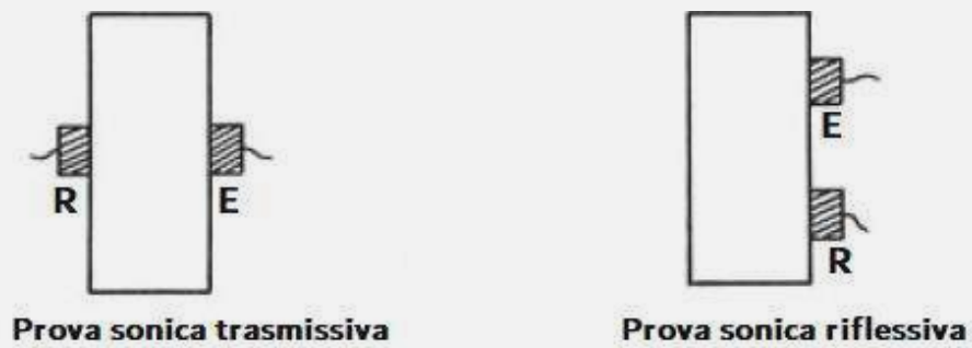
Figura 1.2.8 Geometrie di esecuzione delle prove soniche, trasmissive o riflessive. La lettera E indica l'emettitore dell'impulso, la lettera R indica il ricevitore.
