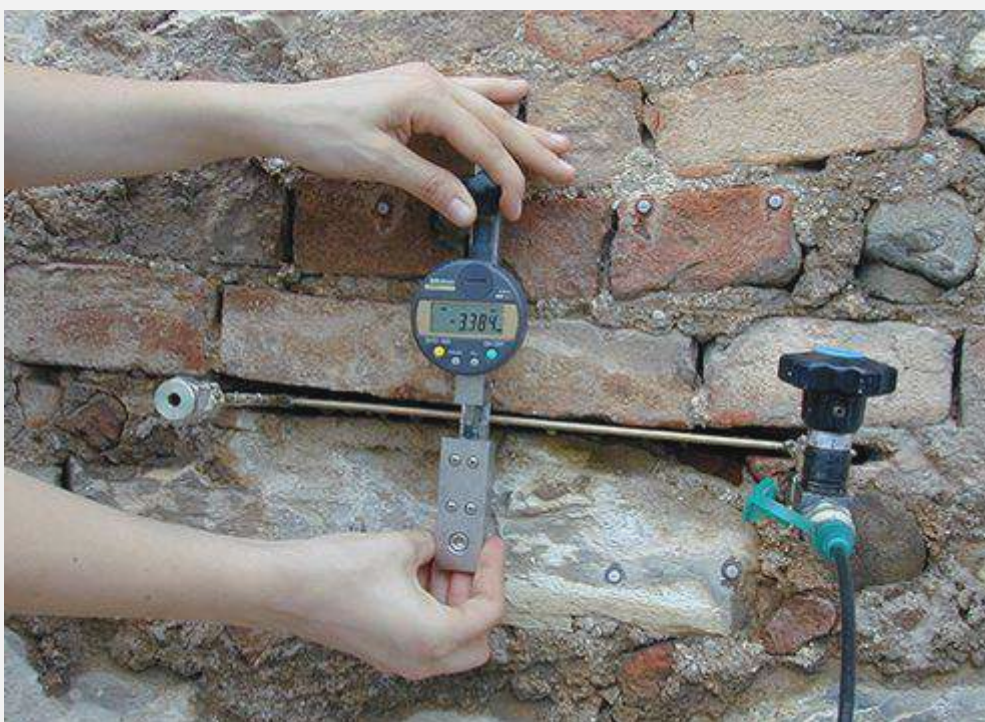
Figura 1.2.5 Esecuzione di una prova con martinetto piatto singolo.
