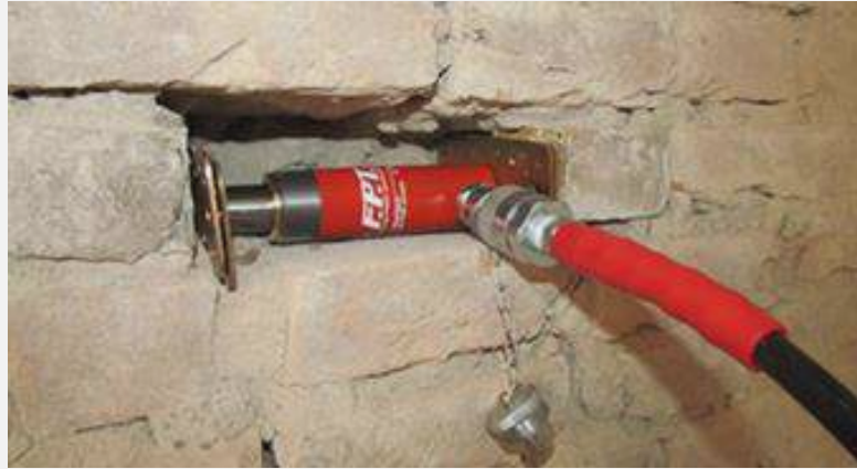
Figura 1.2.7 Esecuzione di uno Shave Test.
