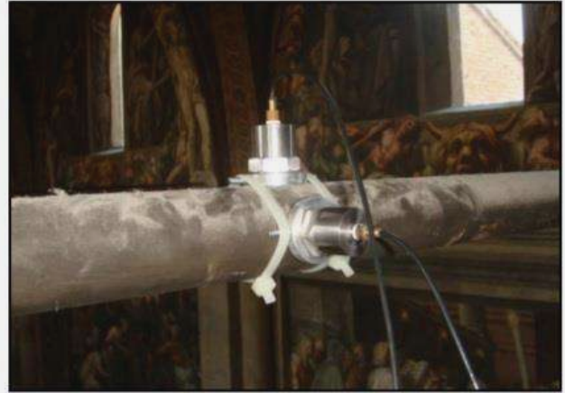
Figura 1.2.13 Attività sperimentale di determinazione dello stato tensionale delle catene presso il Duomo di Parma (GARZIERA, COLLINI 2009)
