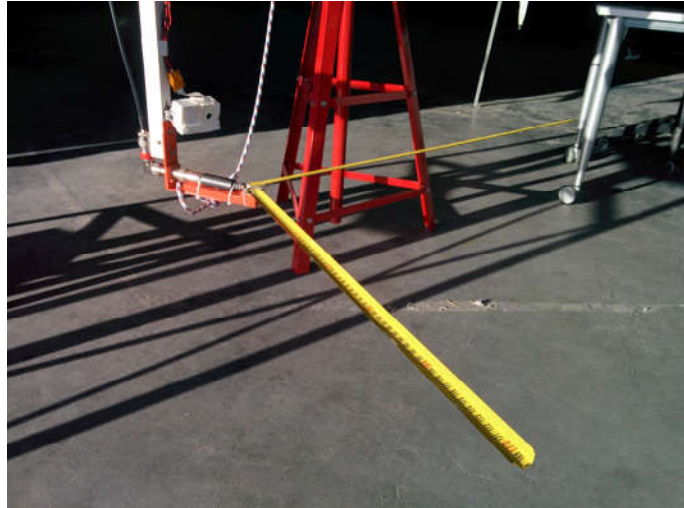
Fig. 3: STRATONAV VHF VOR antenna.
