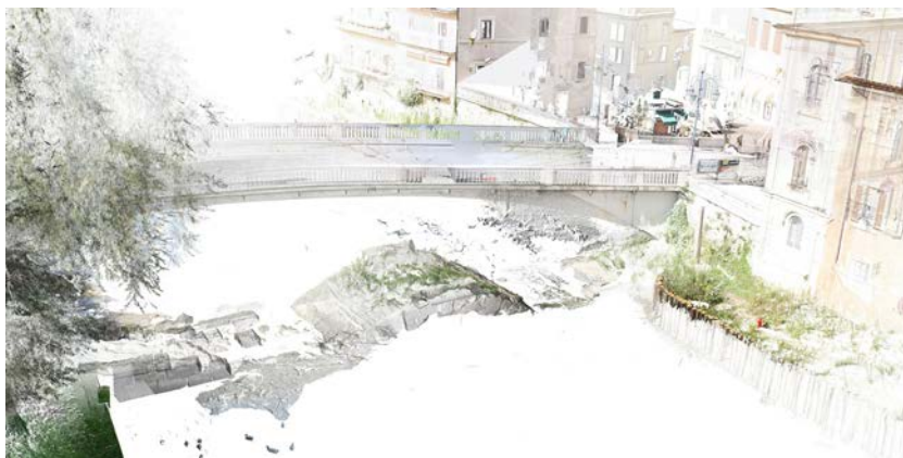
Fig. 5. Vista renderizzata della nuvola di punti acquisita tramite scanner laser terrestre (TLS). Rilievo di Leonardo Paris.
