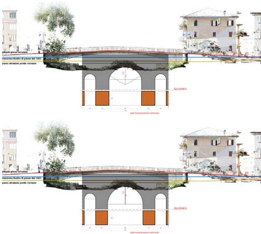
Fig. 16. Ipotesi di possibili configurazioni delle tre arcate del ponte originario (elaborazione di Leonardo Paris).
