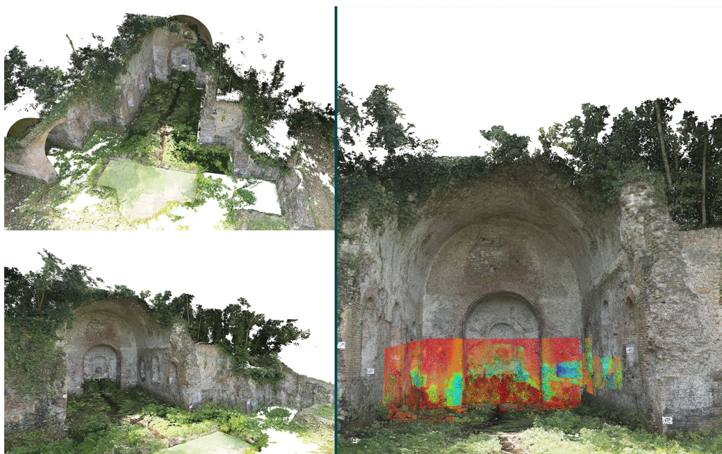
Fig. 3. A destra, la nuvola di punti generata tramite processi di SfM, a sinistra, integrazione con nuvola di punti generata a partire da immagini termografiche [Griffo, Cimadomo, Menconero 2019].
