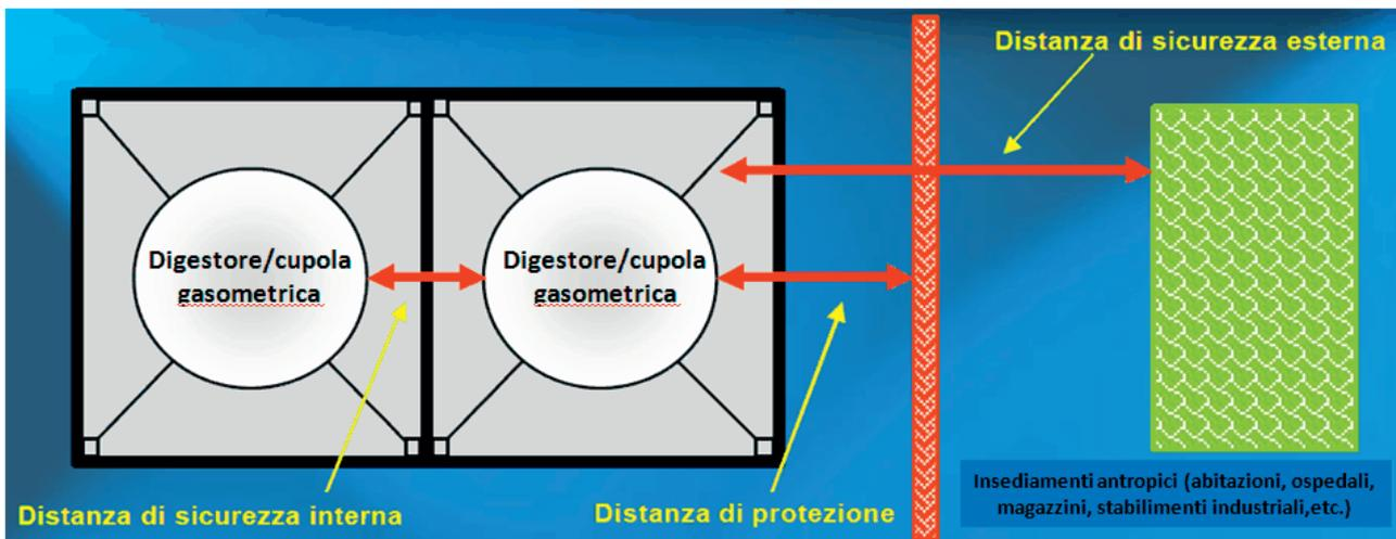
Tutte le distanze citate sono misurate a partire dal contorno della proiezione in pianta degli accumulatori pressostatici e sono state stabilite in funzione del valore assunto dal parametro "capacità di accumulo" (C), misurato in m<sup>3</sup> e definito dalla seguente equazione:
