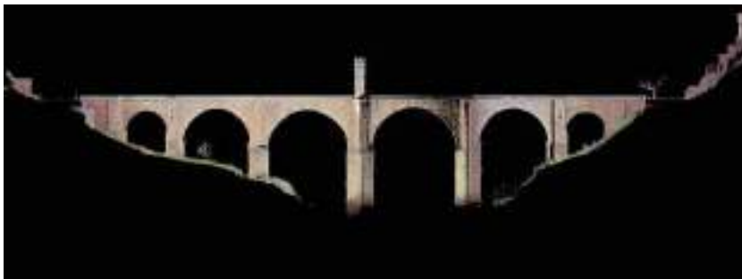
Fig. 6. Ponte di Alcántara, modello numerico, nuvola di punti. Prospetto nord-est (elaborazione di Carlo Inglese).
