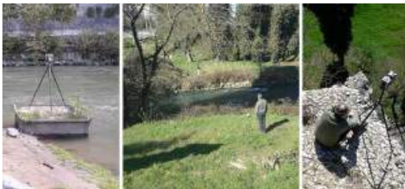
Fig. 3. Difficoltà nel posizionamento dello scanner laser e dei target a riconoscimento automatico. A sinistra: Ponte Emilio; al centro e a destra: Ponte di Augusto a Narni (foto di Leonardo Paris e Wissam Wabbeh).
