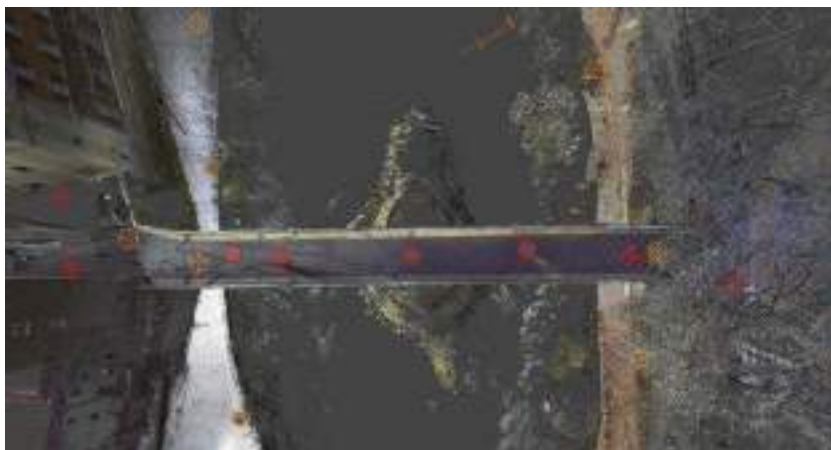
Fig. 7. Nuvola di punti, vista planimetrica, punti di stazione (elaborazione di Daniele Maiorino).
