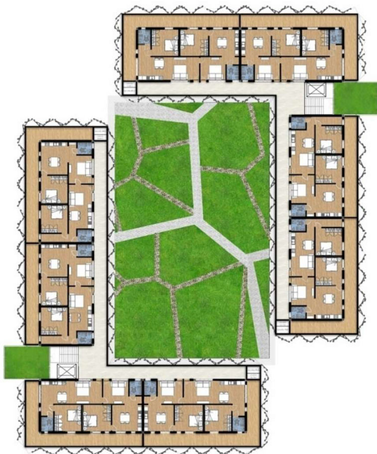
Fig. 44 - Pianta del primo piano del complesso abitativo
