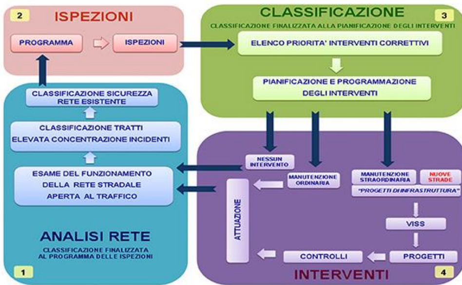
Figura 1 - Il ciclo complessivo delle attività del processo di gestione della sicurezza delle infrastrutture stradali - "Linee guida per la gestione della sicurezza delle infrastrutture stradali", Ministero delle Infrastrutture e dei Trasporti
