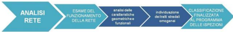
Figura 2 - Le attività della prima parte della macrofase ANALISI RETE - “Linee guida per la gestione della sicurezza delle infrastrutture stradali”, Ministero delle Infrastrutture e dei Trasporti
