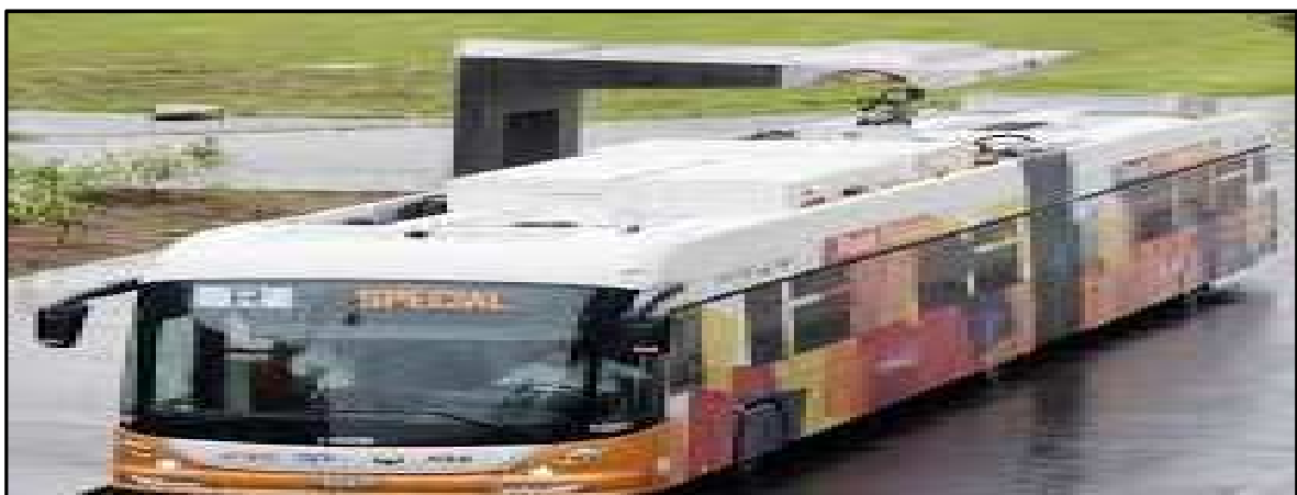
Figura 1.20: Il sistema TOSA di ABB a Ginevra basato su telaio HESS
