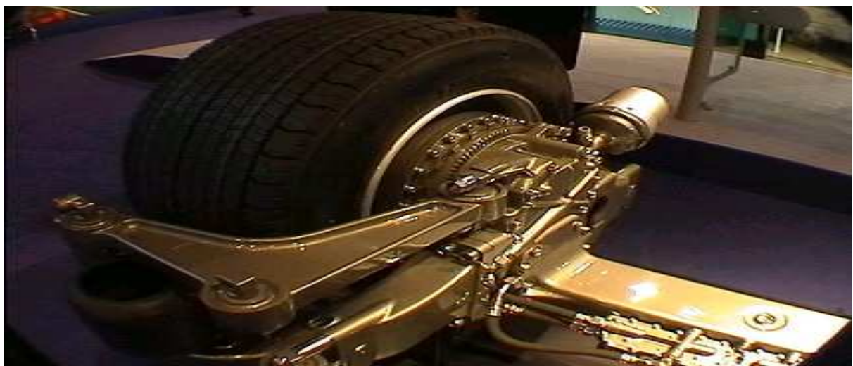
Figura 1.24: I motori montati sul mozzo Ciovis sui due assi posteriori
