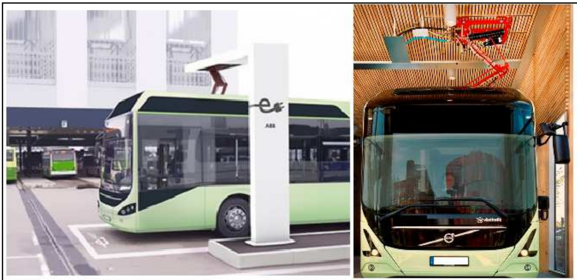
Figura 8.139: Sistema di ricarica a Pantografo
