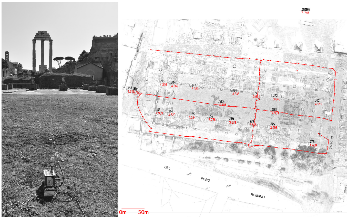
Fig. 4.3 Posizionamento della strumentazione per l'acquisizione ERT (sinistra) e tracciato di acquisizione (destra).
