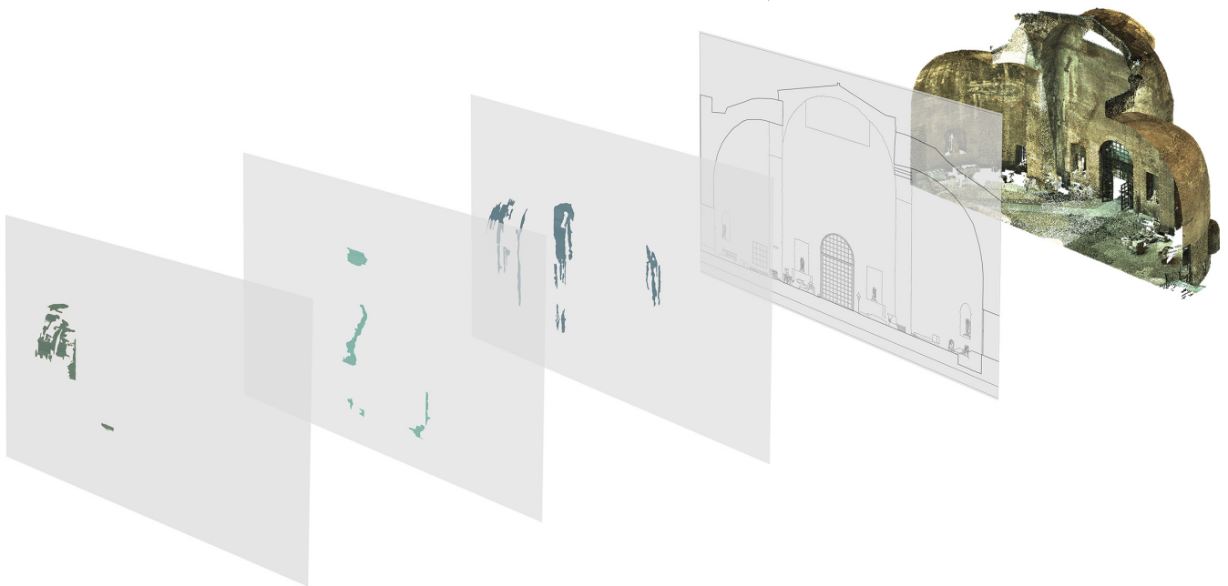
Fig. 4.13 Schema proiettivo degli elaborati 2D sulla nuvola di punti 3D per la segmentazione.
