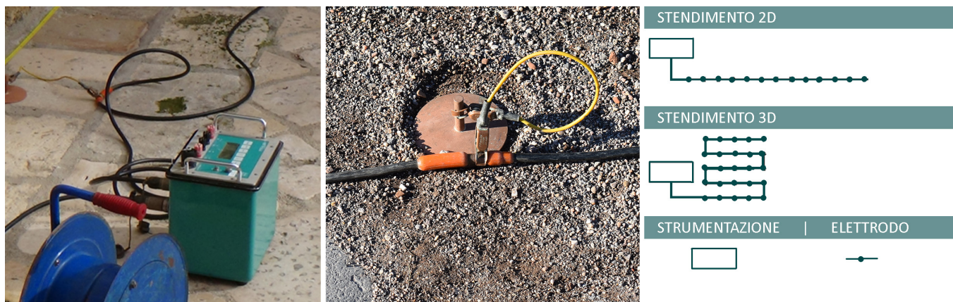
Fig. 2.9 Da sinistra: strumentazione 3D, elettrodo e schema di stendimento degli elettrodi. Progetto Basilica Iulia, 2019 (nota 3, pag.108).
