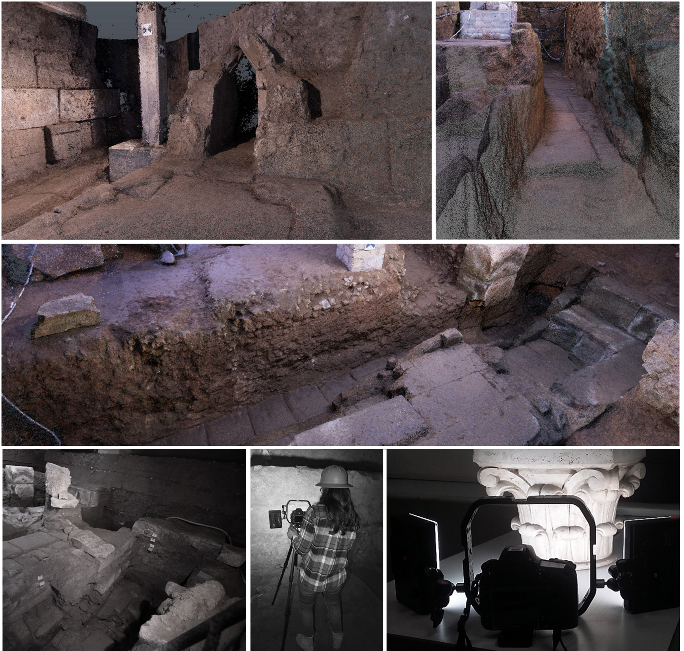
Fig. 4.2a In alto: viste prospettive del modello numerico. In basso da sinistra: condizioni di illuminazione del saggio e configurazione spaziale, acquisizione con camera cage, configurazione della strumentazione.
