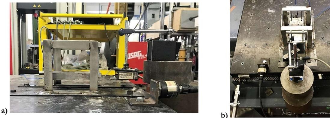
Figura 7. 4 Setup della prova sperimentale – L'HVA sullo shaker dinamico a) vista laterale; b) vista dall'alto
