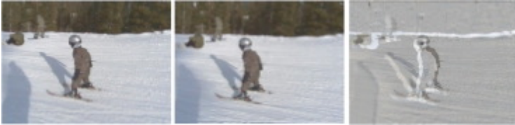
Figura 18.30: Due fotogrammi consecutivi, e la differenza tra i rispettivi valori di luminanza
