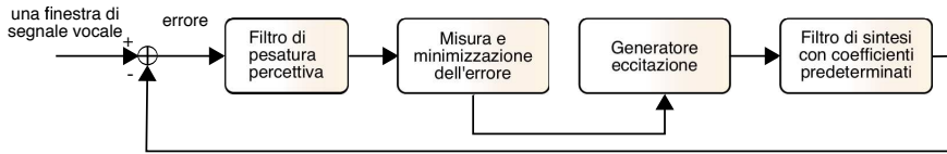
Figura 18.13: Schema di codifica vocale ABS - Analysis by Synthesis
