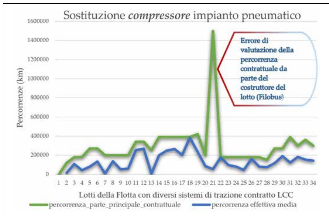
Figura 3 - Dato di percorrenza contrattuale errato in fase di progetto
