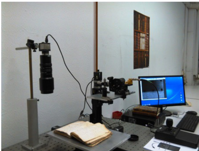
[Fig. 13.2. Il prototipo THESMA, integrato con il software per il movimento del microscopio e per la rilevazione dei dati].
