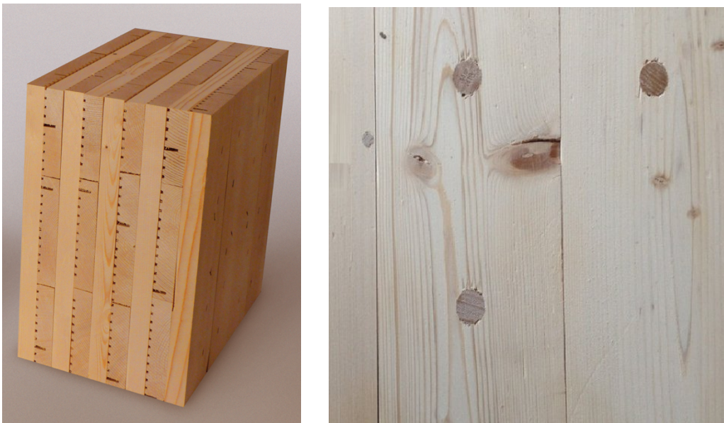
Figura 64 Due diversi pannelli Xlam senza colle: a sinistra un pannello con lamelle rese solidali mediante graffatura di spille in alluminio, a destra mediante chiodi in faggio.
