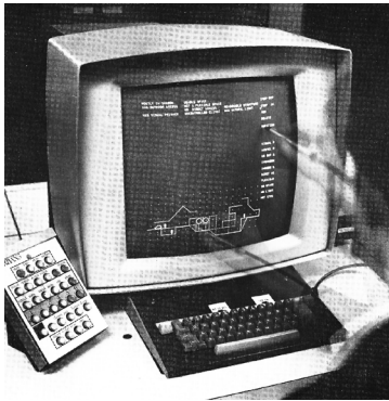
Fig 2. 3 Overlay di URBAN 5 IBM modello 2250 a tubo catodico usato per URBAN 5. Fonte: openarchitecture.com
